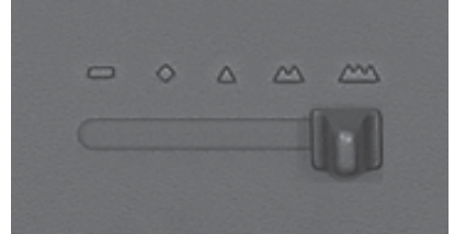
Abb. 3.6 Verbrennungslufthebel ganz rechts - Verbrennungsluft komplett geöffnet
