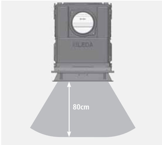
Abb. 1.2 Strahlungsbereich der Sichtscheibe - schematische Darstellung
