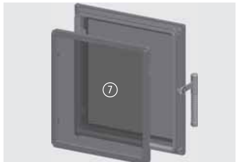
Abb. 3.14 Einbau des Dichtrahmens
