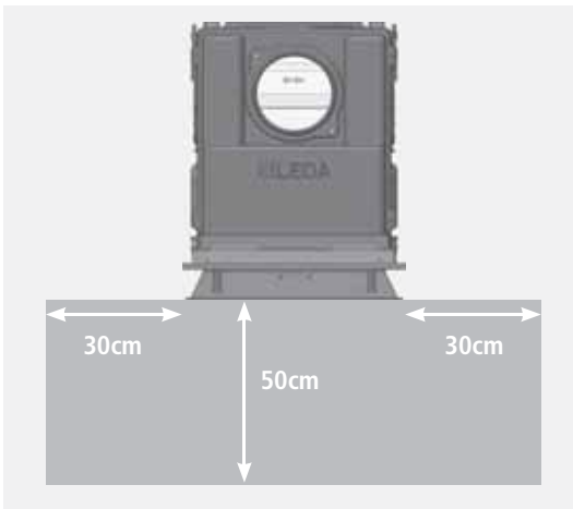
Abb. 1.1 nicht brennbarer Belag vor der Feuerraumöffnung - schematische Darstellung
